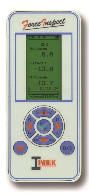
Der Messbereich ist abhängig von den angeschlossenen DMS-Vollbrücken-Sensoren.
